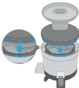
**5** Komoru namontirajte na bazu uređaja.
