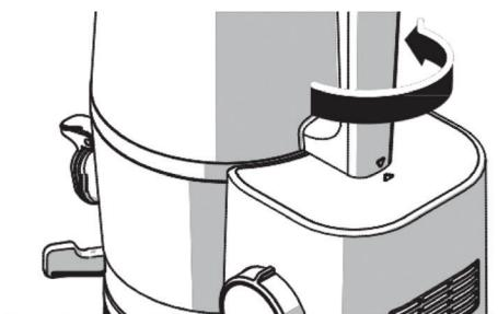
Ako se komora ne odvaja lako od cevi, odvojite cev, dok je komora još povezana sa bazom i cev isperite pod tekućom vodom.
