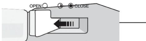
Kada rastavljate i čistite komoru, kontrolnu ručicu postavite u ○ Open poziciju. Na ovaj način ćete lako očistiti komoru. Kontrolna ručica neće upasti u ○ Open poziciju sve dok komora stoji na bazi.
