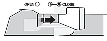
**1** Kontrolnu ručicu postavite u Close poziciju, pre nego što počnete sa ceđenjem. Komora neće biti spojena sa bazom ako kontrolna ručica nije u Close poziciji.
