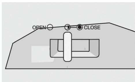
Ako se cev ne otvara lako nakon upotrebe, kontrolnu ručicu stavite u poziciju half open i izvadite svu pulpu iz komore, pa potom upotrebite opciju REV na 2-3 sekunde, pa ceo process ponovite dva ili tri puta. Nakon ovoga će biti moguće da lagano otvorite poklopac na komori.
