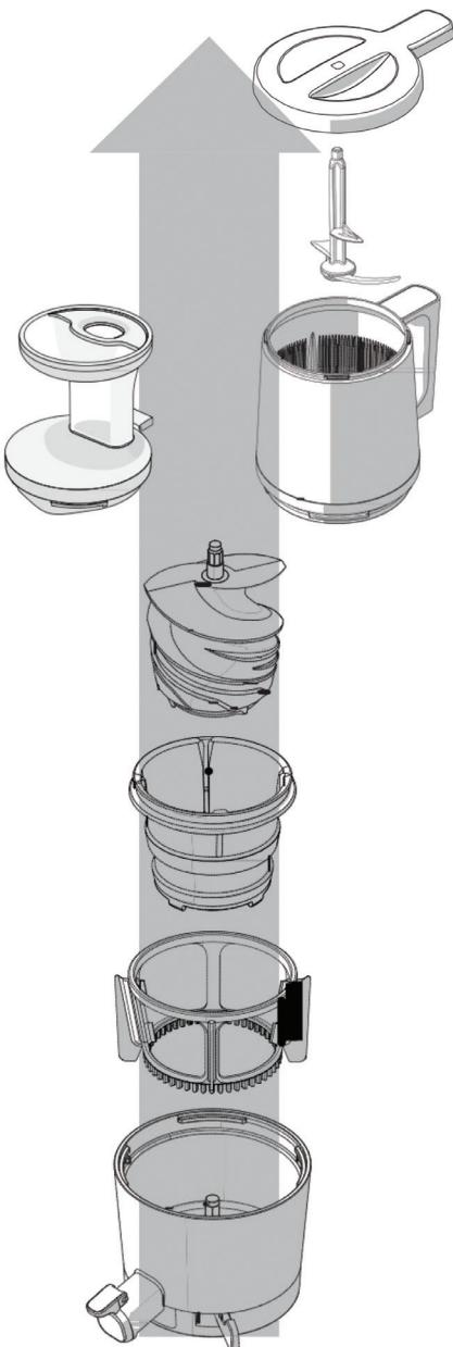
**1** Poklopac na cevi okrenite u smeru suprotnom smeru kazaljke na satu kako biste aotvorili cev i izvadite polugu za mešanje, pa potom odvojite komoru i cev tako što ćeete cev okrenuti smeru kazaljke na satu.
