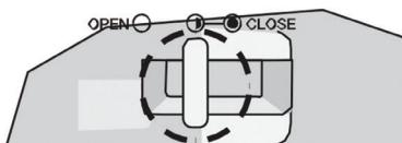
Nakon što su svi sastojci prošli kroz komoru, kontrolnu ručicu ubacite u ● Half close poziciju i ostavite uređaj da radi sve dok sva pulpa ne izađe iz uređaja. Morate izbaciti svu pulpu kako biste mogli otvoriti cev.
