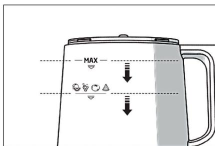
**03 PRIPREMITE SASTOJKE PRE NEGO ŠTO IH UBACITE U UREĐAJ** Nepripremljeni sastojci se mogu nakupiti oko poluge za mešanje, što može dovesti do oštećenja ili prekida rada uređaja.
