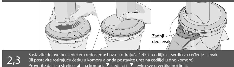
**2,3 Sastavite delove po sledećem redosledu: baza - rotirajuća četka - cediljka - svrdlo za cedenje - levak (ili postavite rotirajuću četku u komoru a onda postavite urez na cediljci u dno komore). Proverite da li su strelice ▲ na komori, ▼ cediljci i ▽ levku sve u vertikalnoj liniji.**
