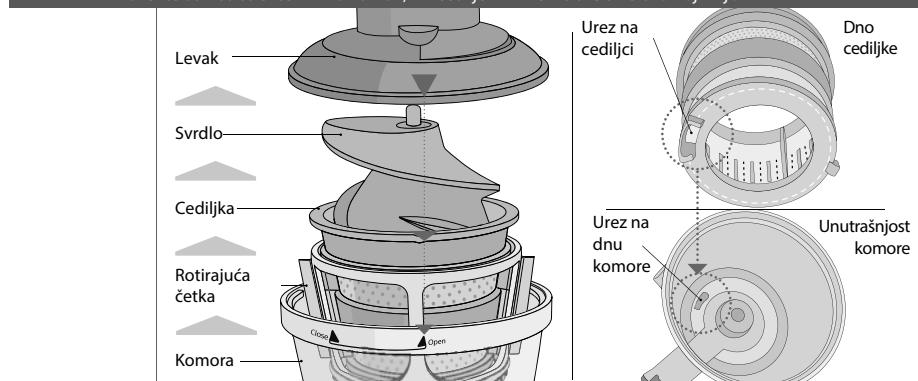
**1 Čvrsto postavite poklopac za pulpu na dno komore, u izlaz za pulpu. Uverite se da su se urezi poravnali sa urezima na bazi i okrenite u smjeru kazaljke na satu.**
