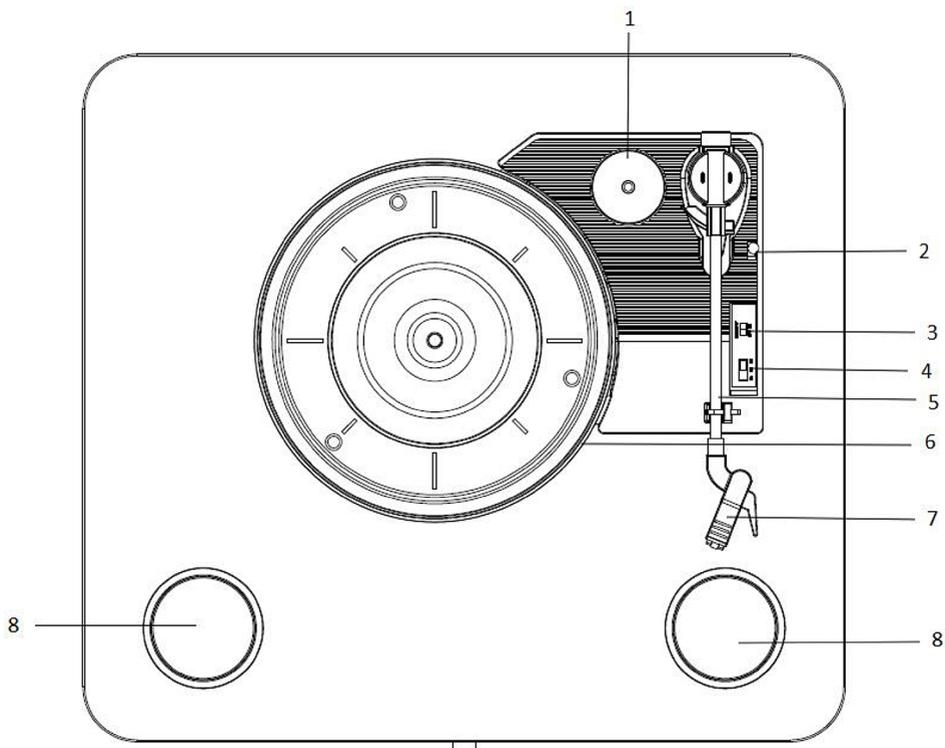
1. 45 rpm držač adaptera- koristi se za puštanje ploča od 45 rpm, sa sečenim centrom
